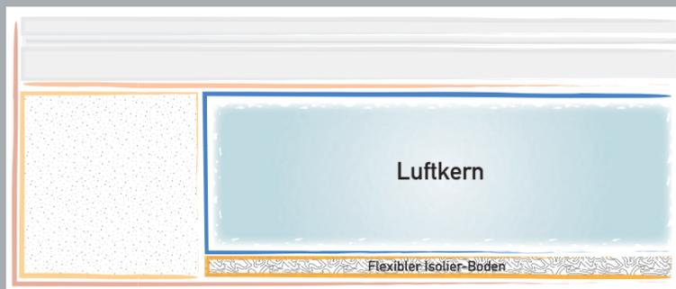
Ein Mehrkammer-Luftkern inkl. Füllkompressor und Fernbedienung wird auf einen flexiblen Isolier-Boden aufgelegt. Schulterzone und Mittelbereich können unabhängig voneinander befüllt werden.
