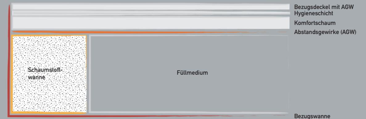
Eine Wanne aus hochwertigstem Schaumstoff findet im Sitzbereich Anwendung. Die Schaumstoffwanne ist zum Schutz mit einem scheuerfestem Vlies ummantelt. Das Vlies ist mit lösemittelfreiem Kleber auf Wasserbasis verklebt.
