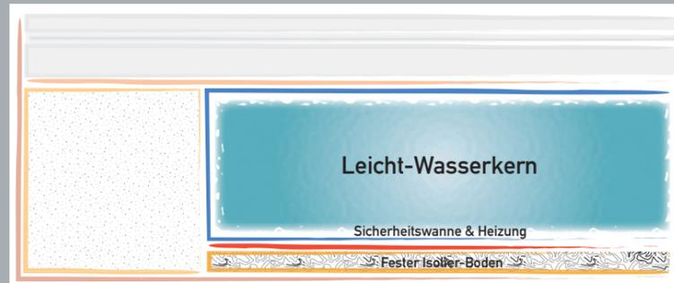
Ein Wasserkern mit verschiedenen Dämpfungsstufen wird inkl. Sicherheitswanne und Heizung auf einen festen Isolier-Boden aufgelegt.
