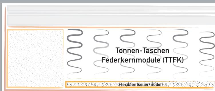
Ein Mehrzonen-Federkern mit jederzeit anpassbaren variablen Härtegraden. Der flexible Isolier-Boden kann zusätzlich zur Anpassung des Härtegrades verwendet werden.
